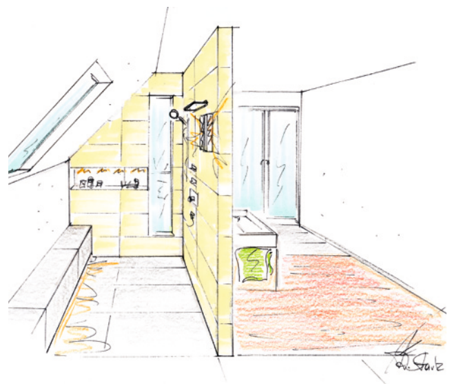
Abb. 5.13: Die Dusche ist unterhalb eines Dachfensters platziert.
