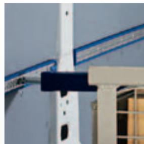
Zurrschienen an den Laderaumwänden für die Aufnahme von Spannstangen und zur Sicherung der Ladung mit Spanngurten
