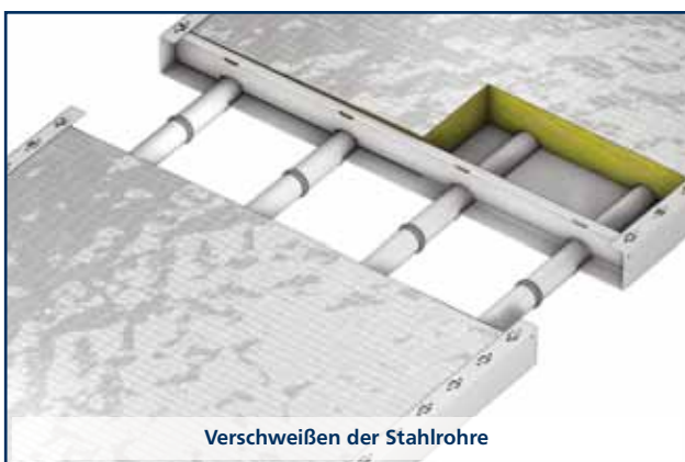
Verbindung der Stahlrohre mit Press-Schiebemuffen
