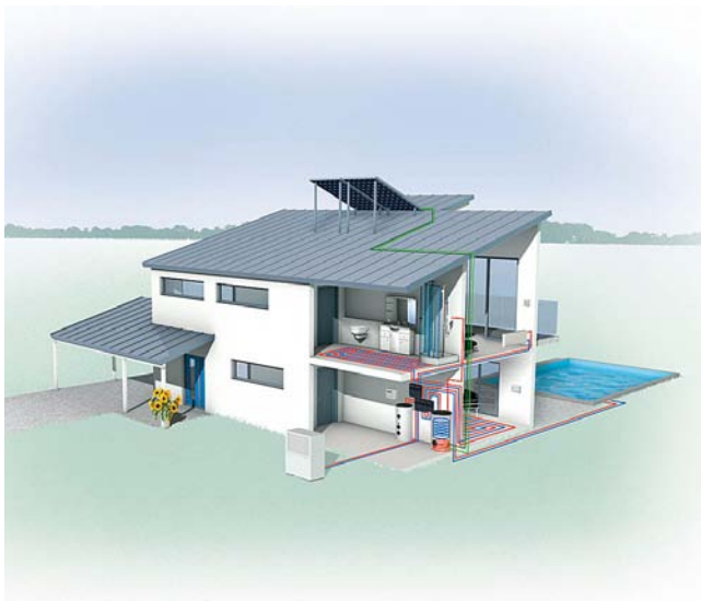
Abb. 1.16: Luft/Wasser-Wärmepumpenanlage mit solarer Warmwasserbereitung in bivalentem Solarspeicher
