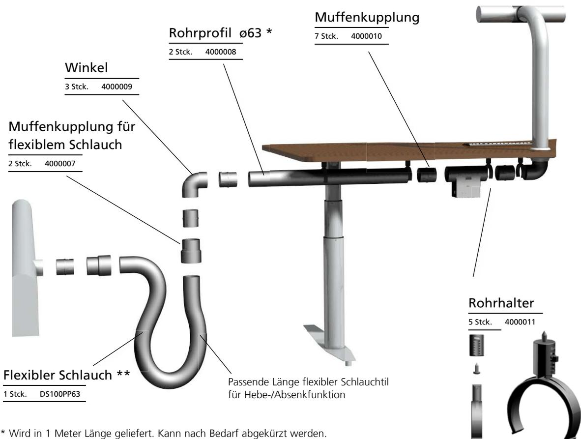
\* Wird in 1 Meter Länge geliefert. Kann nach Bedarf abgekürzt werden. Eventuell Plastikrohrschneider benutzen.
