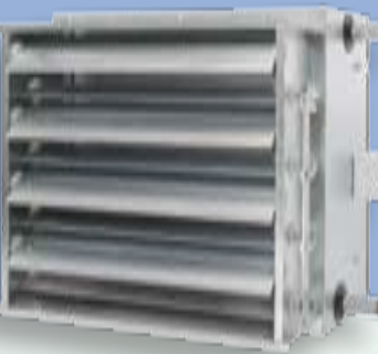
Ausblasvariante: Wand, 1-seitig Energiesparjalousie 505 mit Lenk- (LJ) und Drosseljalousie (DJ) LJ von Hand oder durch Stellmotor, DJ von Hand, Stellmotor oder über Ausdehnungszyylinder einstellbar
