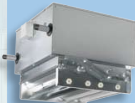
Ausblasvariante: Decke, 2-seitig Energiesparjalousie 506 mit Lenk- (LJ) und Drosseljalousie (DJ) LJ von Hand oder durch Stellmotor, DJ von Hand, Stellmotor oder über Ausdehnungszyylinder einstellbar
