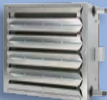
Ausblasvariante: Wand, 1-seitig Energiesparjalousie 505 mit Lenk- (LJ) und Drosseljalousie (DJ) LJ von Hand oder durch Stellmotor, DJ von Hand, Stellmotor oder über Ausdehnungszyylinder einstellbar
