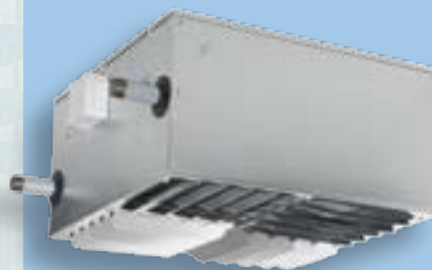
Ausblasvariante: Decke, 4-seitig Ausblasjalousie 502 (nur für Decke) Lamellen von Hand nach außen einstellbar
