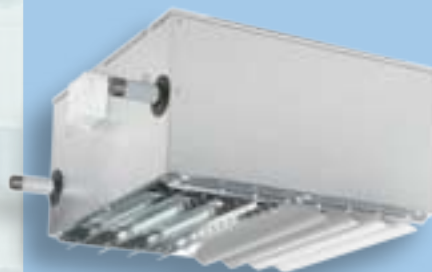
Ausblasvariante: Decke, 4-seitig Ausblasjalousie 500 (Standard) mit Unterbau-Ausblasjalousie 503 , 2-seitig, 90° versetzt Lamellen von Hand nach innen einstellbar
