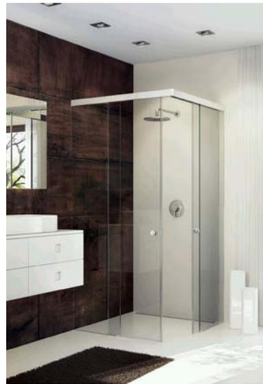
Die Schiebetürdusche „Tansa“ der Sprinz GmbH & Co. KG ist aus 8 mm starkem Einscheiben-Sicherheitsglas gefertigt. Der Schiebekomfort wird durch eine integrierte Dämpfung mit Selbsteinzug sowie Zuhaltung nochmals verbessert. Die Schließ- und Öffnungsdämpfung „Soft-Stop“ ist unsichtbar in der Laufschiene eingebaut und kann beidseitig montiert werden. Das Sicherheitsglas kann zusätzlich mit der
